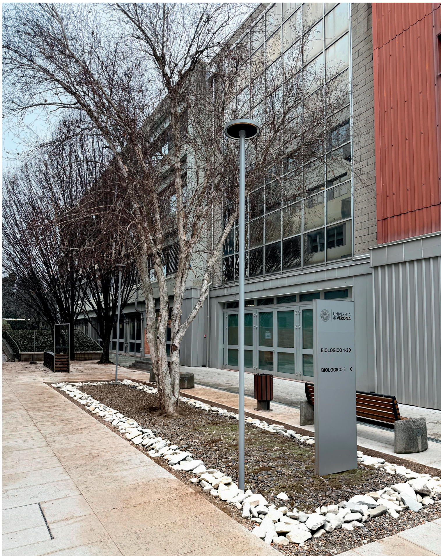
Palo Monaco60 H 3000 mm grigio metallizzato RAL 9006 raggrinzito (a richiesta) - incastrato: incassato in fondazione di calcestruzzo
