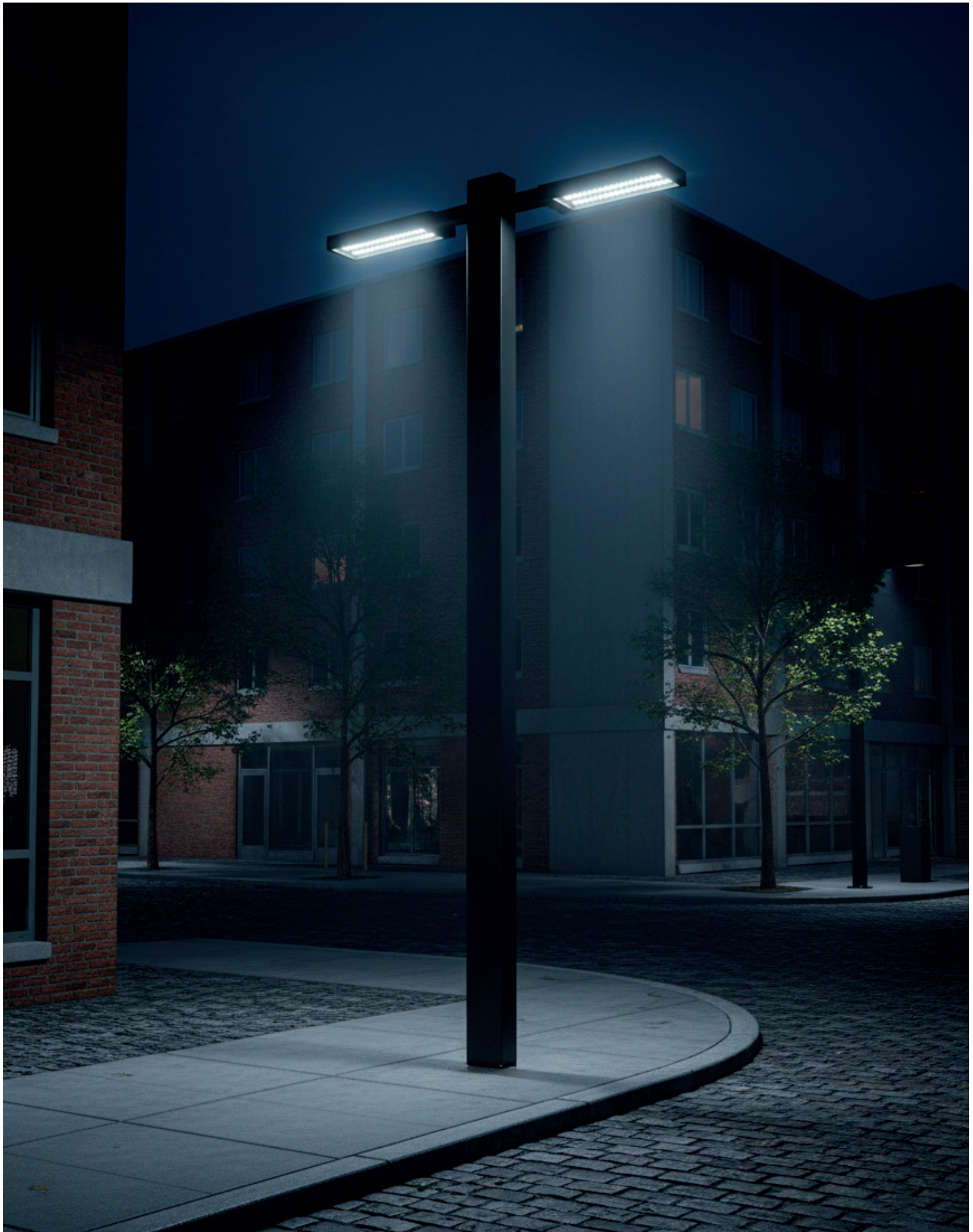
Palo Boston120 H 3500 mm nero RAL 9005 raggrinzito - incastrato: incastrato in fondazione di calcestruzzo con sbraccio doppio Ø 60 mm passante integrato nel palo senza saldatura o viti esterne cod. SB2620FE a p. 92
